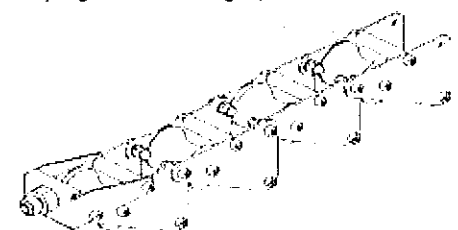
Figura 4.1: Rodillos de cable para el fondo de los pozos (MK2)
